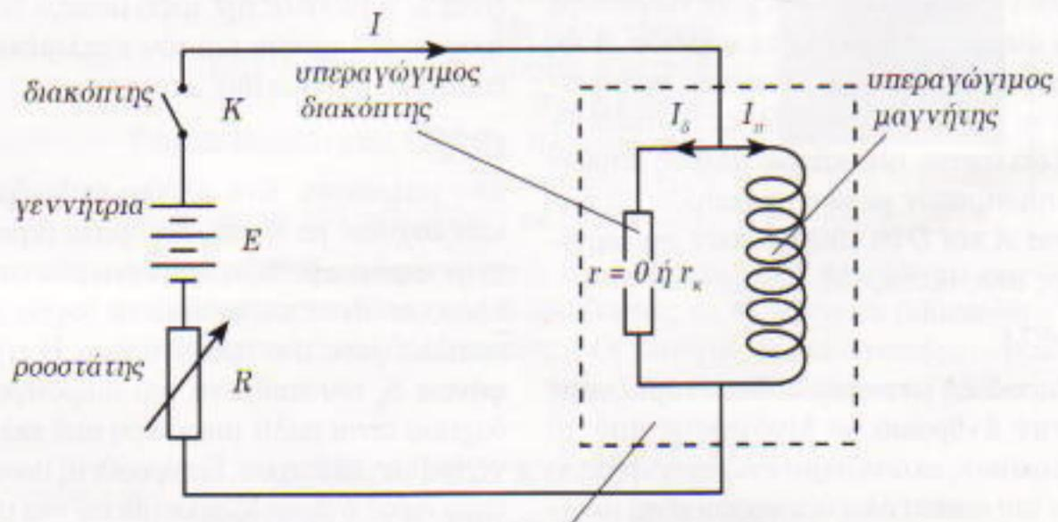
το μέρος που περικλείεται από τη διακεκομένη γραμμή είναι βυθισμένο σε υγρό ήλιο θερμοκρασίας 4.2 Κ
